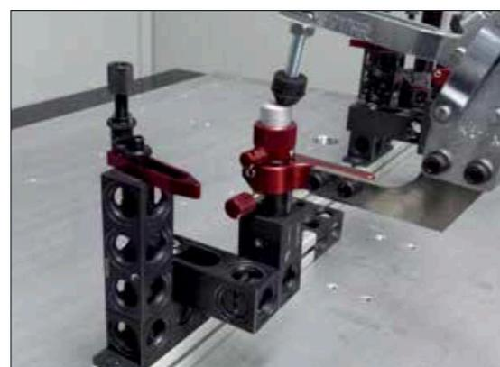
1.70. BARRA 30x30mm - CONEXÃO SJS dimensão 60x30x30mm, 2 furos
